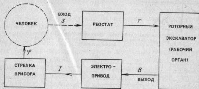
5. Принцип действия системы регулирования скорости движения роторного экскаватора
