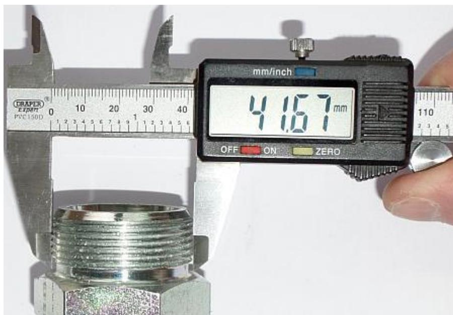
Рис 6.20. Измерение наружного диаметра резьбы штангенциркулем
