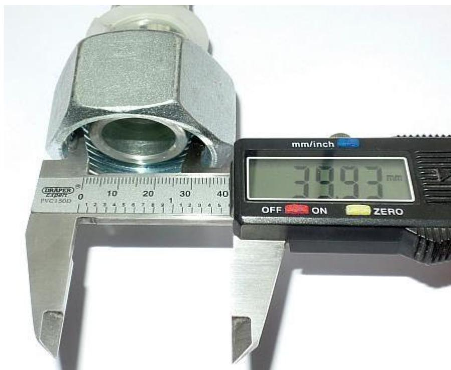
Рис 6.23. Измерение внутреннего диаметра резьбы штангенциркулем
