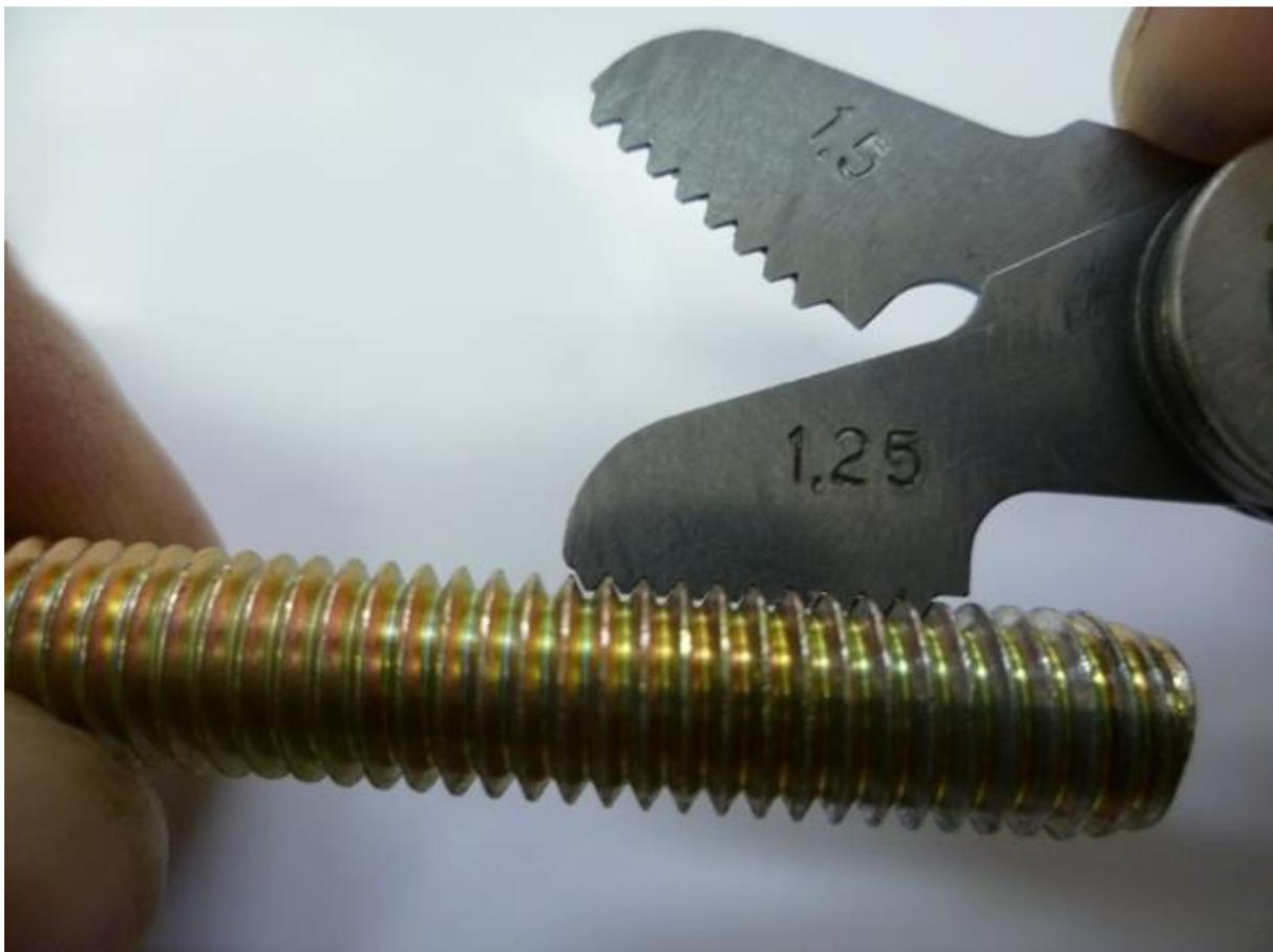
Рис. 6.22. Определение шага резьбы резьбомером
