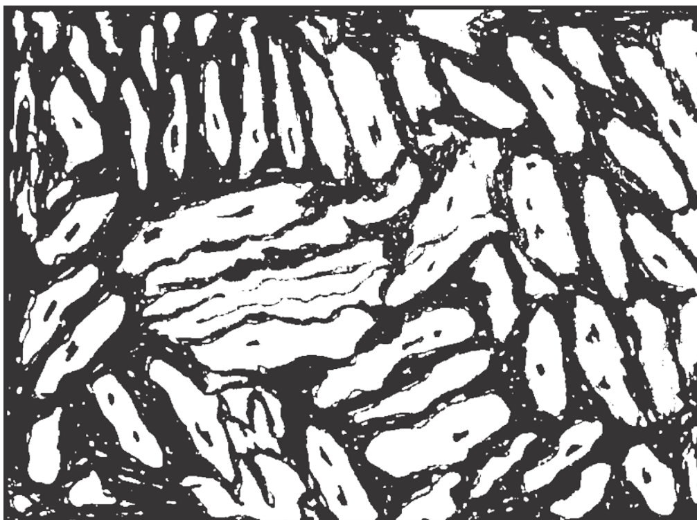
Рис. 5.9. Бронза БрАЖН10-4-4: \alpha -фаза, эвтектоид и включения железа
