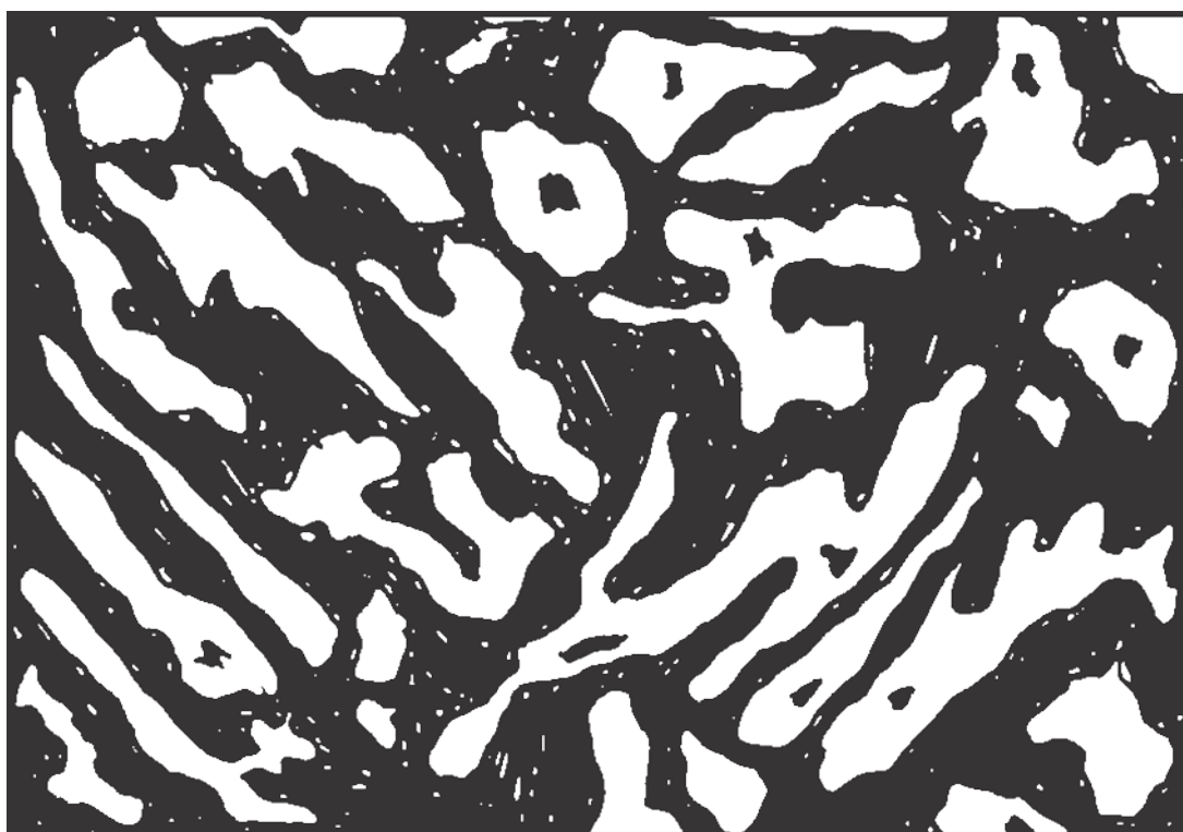
Рис. 5.7. Латунь ЛС59-1: \alpha - и \beta -фазы и включения свинца, \times 450
