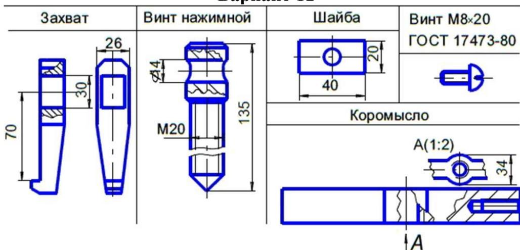
**Примечание.** Съёмник предназначен для снятия различных деталей с валов. Изображения деталей, входящих в съёмник, приведены выше.
