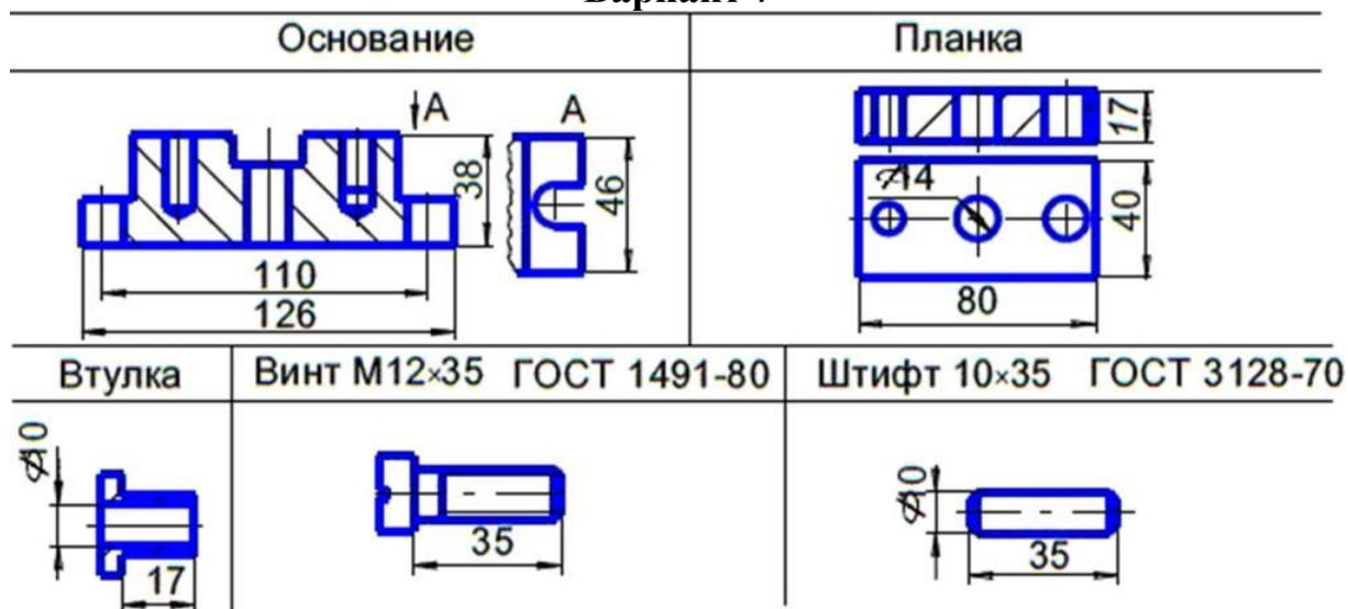
**Примечание.** Кондуктор предназначен для обеспечения пространственной ориентации режущего инструмента относительно обрабатываемого изделия. Изображения деталей, входящих в кондуктор, приведены выше.
