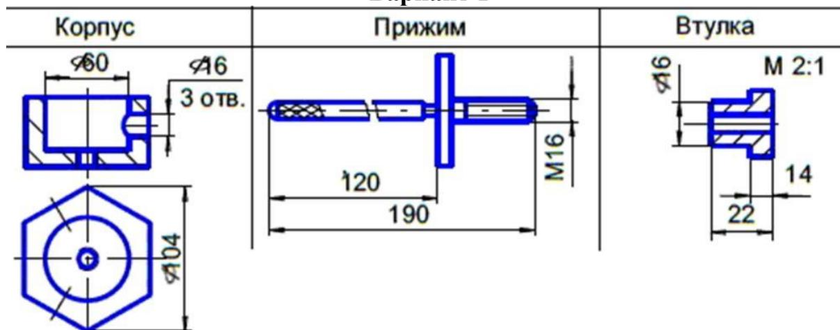
**Примечание.** Кондуктор предназначен для обеспечения сверления трех отверстий под углом  $120^\circ$  друг к другу на втулках, устанавливаемых внутри корпуса. Изображения деталей, входящих в кондуктор, приведены выше.
