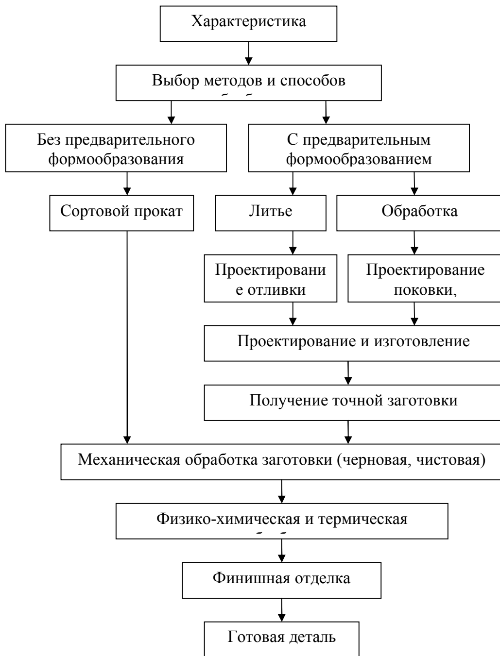
Рис. 2. Возможные варианты технологий получения деталей машин
