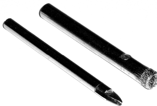
Рис. 8. Конструкции сверл: клинообразное и трубчатое (с напыленной алмазной крошкой) для сверления керамики и стекла
