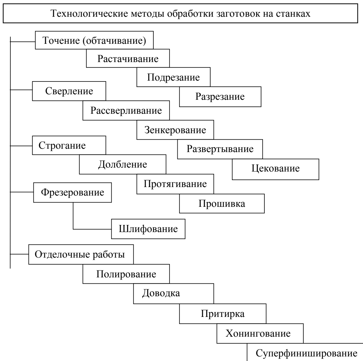
Рис. 5. Основные операции обработки заготовок резанием
