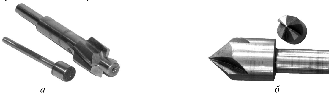
Рис. 10. Зенковки: а – торцовые; б – конические
