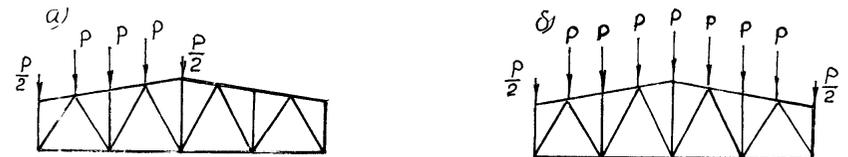
Рис. 10. Схемы загрузки ферм временной нагрузкой:
