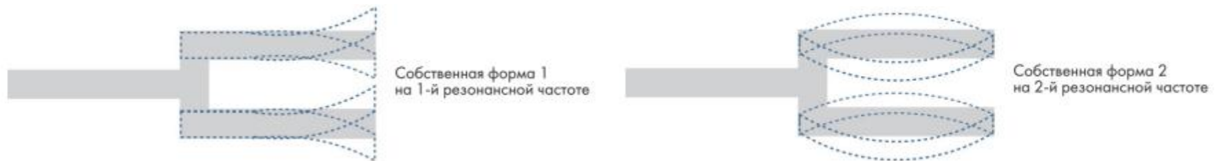
Рис. 3.1. Первая и вторая собственные формы колебаний вилочного камертона
