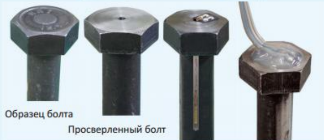
Утопленный тензорезистор
