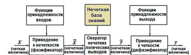
Рис. 7. Схема нечёткого логического вывода
