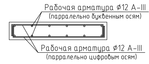
Деталь армирования плиты площадки ПП-1
