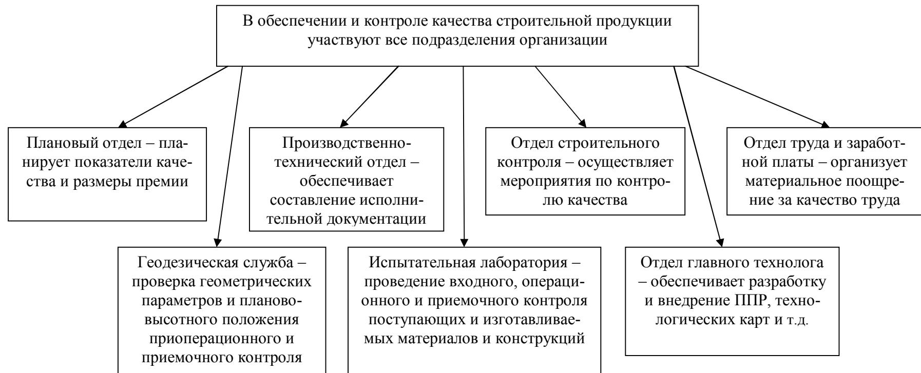
Рис. 7.15. Структура служб технического контроля в строительной организации и их функциональное назначение
