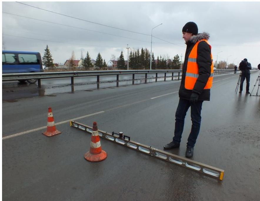
Рис. 5.48. Диагностика технического состояния автомобильной дороги Омск – Русская Поляна
