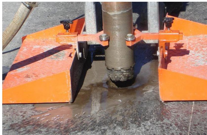
Рис. 7.8. Отбор кернов из асфальтобетонного покрытия
