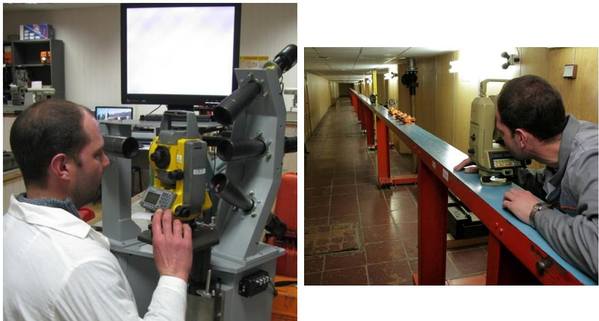
Рис. 7.20. Проверка тахеометра (слева) и лазерного дальномера (справа)
