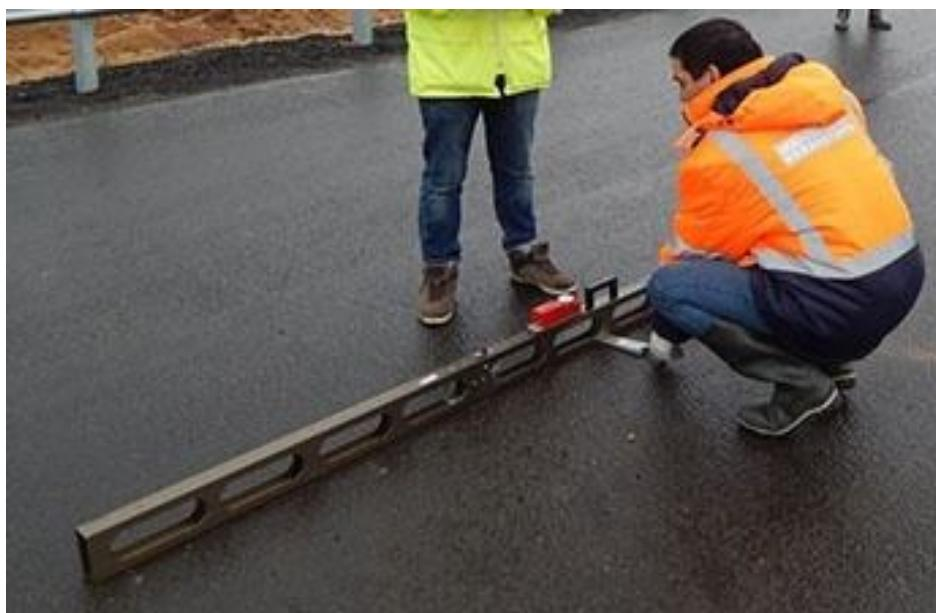
Рис. 7.7. Контроль ровности покрытия с использованием трехметровой рейки
