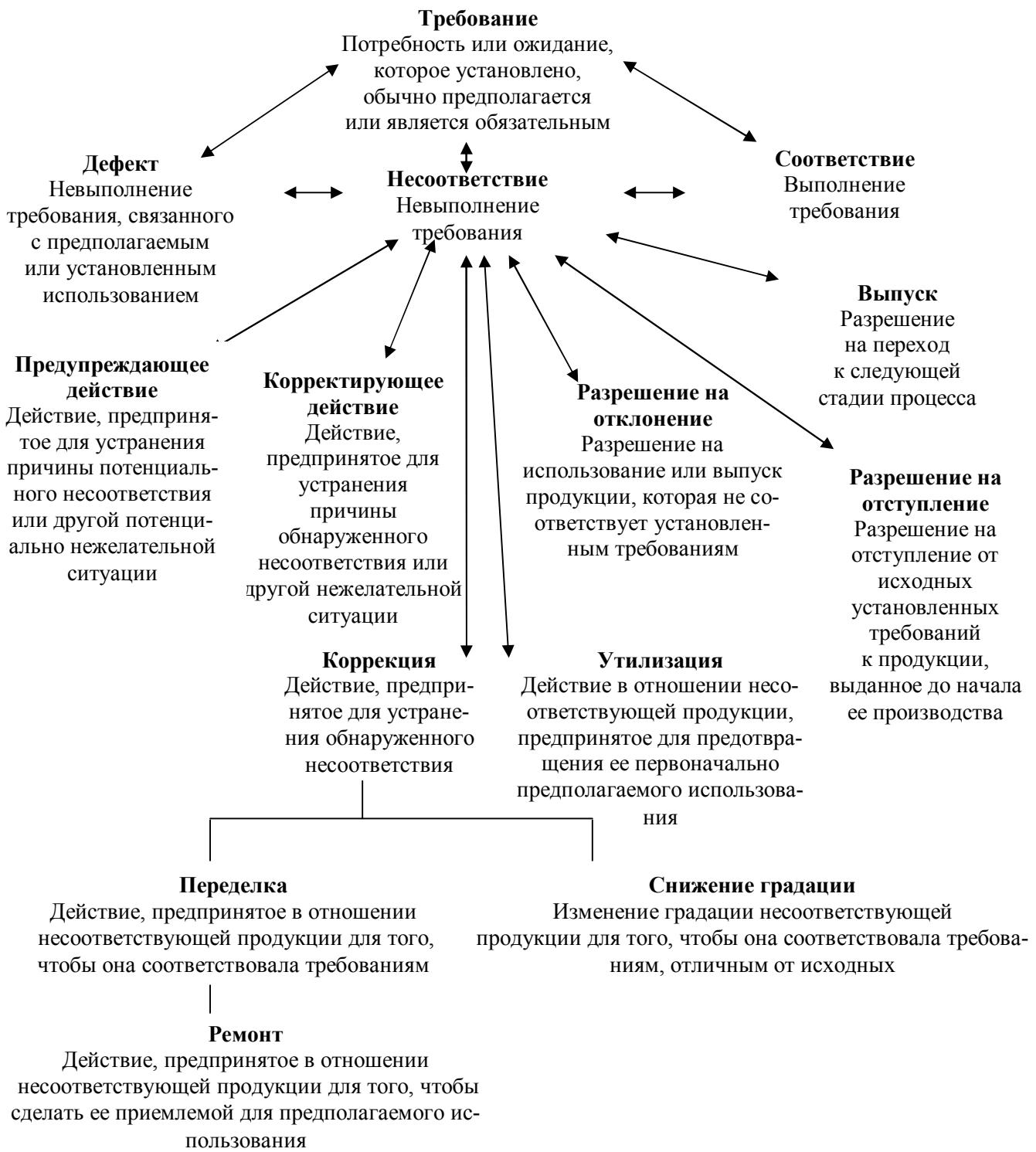
Рис. 3.5. Схема работы организации в определениях системы менеджмента качества
