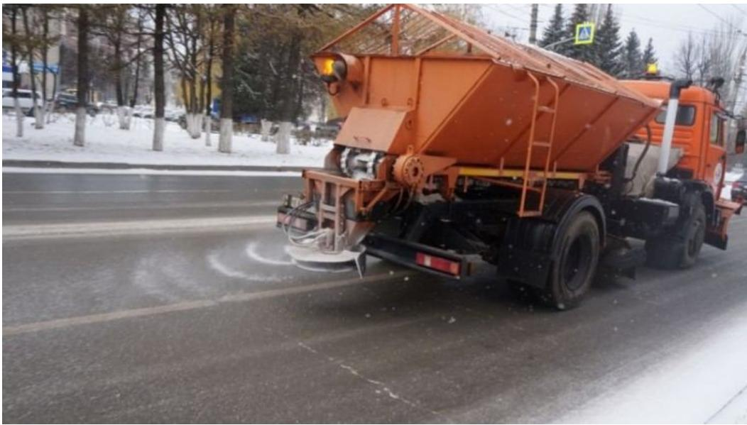
Рис. 5.45. Распределение противогололедной смеси
