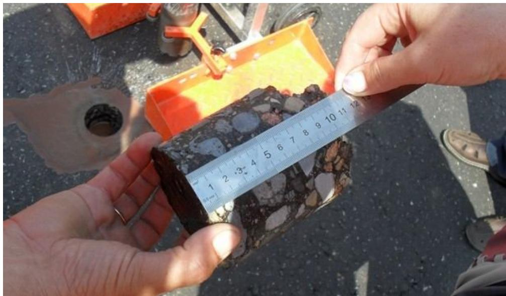
Рис. 7.13. Определение толщины асфальтобетонного покрытия по кернам
