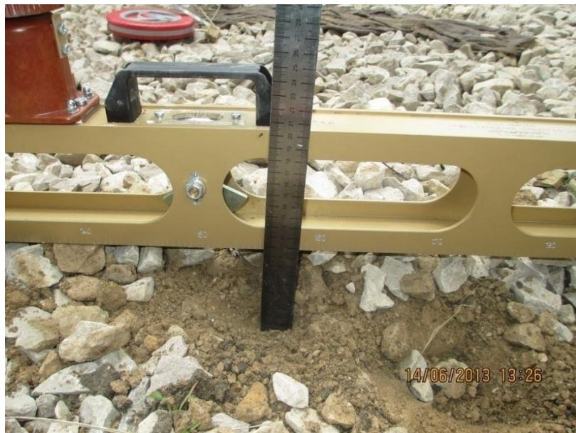
Рис. 7.3. Операционный контроль толщины щебеночного слоя
