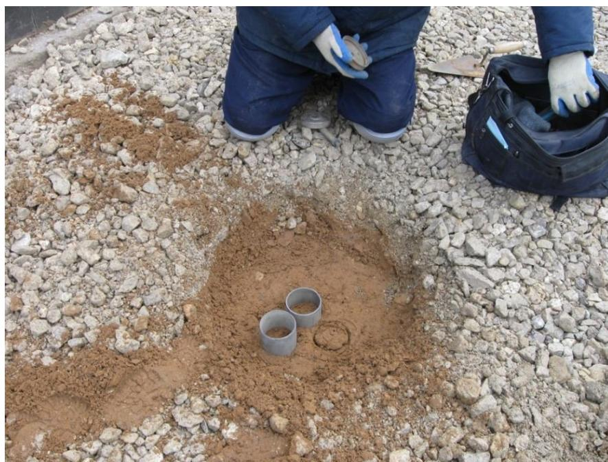
Рис. 7.4. Отбор проб уплотненного слоя грунта методом режущего кольца
