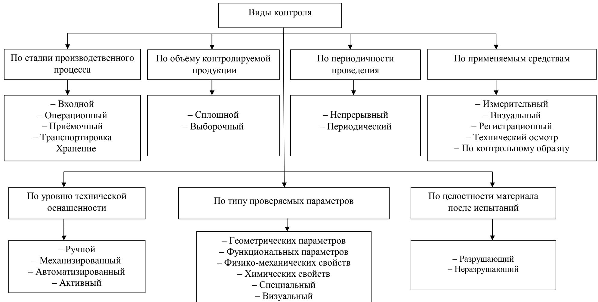
Рис. 7.12. Классификация основных видов контроля
