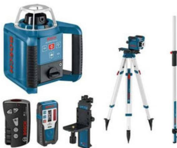
"GRL 300 HV" - это ротационный лазерный прибор с функцией автоматического нивелирования в горизонтальной и вертикальной плоскостях, как внутри зданий, так и снаружи. Точность нивелирования  $\pm 0,1$  мм/м. Диапазон самонивелирования до  $\pm 8\%$  ( $\pm 5^\circ$ ). Дальность лазерного луча до 300 м с приемником. Надежная работа нивелира обеспечивается благодаря функции защиты от вибрации. У прибора несколько режимов: точный, линейный и круговой для
