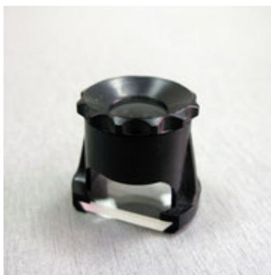
Лупа "ЛИ-3-10х", выполненная по ГОСТу 25706-83, предназначена для измерений линейных размеров на плоскости. Измерение осуществляется с помощью измерительной шкалы, которую видно в поле зрения лупы.
