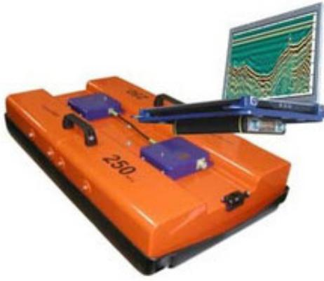
геофизического оборудования. Работа георадара основана на свойстве радиоволн, отражаться от границ раздела сред с различной диэлектрической проницаемостью или проводимостью. При перемещении георадара по поверхности исследуемой среды на экран монитора выводится совокупность сигналов (радарограмма или профиль), по которому можно определить местонахождение, глубину залегания и
