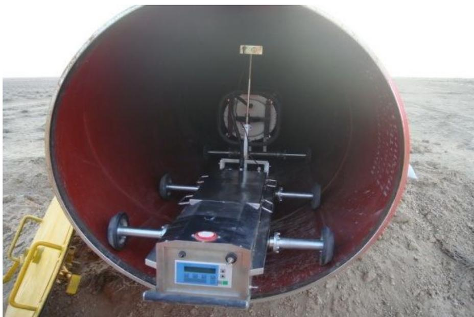
Далеко не всегда есть возможность доставить установку в место проведения исследований. В этом случае пользуются специальными кроулерами — компактными рентгенографическими приборами. Они движутся внутри трубы без проводов. Управляются устройства, осуществляющие радиографический контроль сварных соединений газопроводов и трубопроводов, дистанционно. Такие приборы могут работать в трубах диаметром 325 мм и более.
