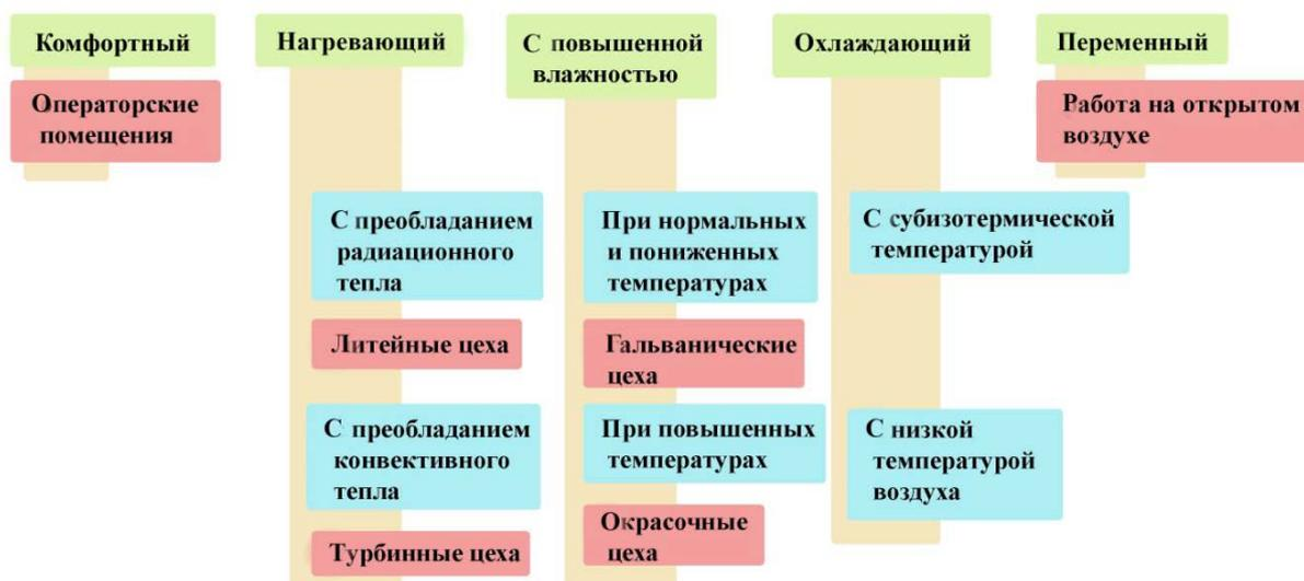
Рис. 4.3. Классификация производственных помещений по производственному микроклимату
