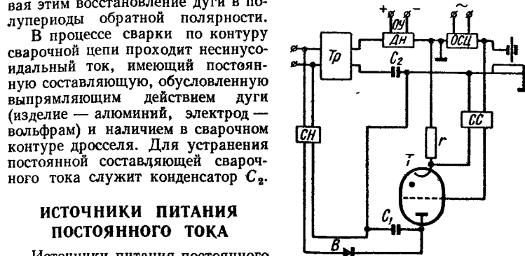
Рис. 44. Принципиальная электрическая схема импульсного стабилизатора
