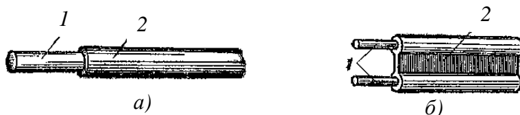
Рис. 27. Провода установочные с изоляцией из полихлорвинилового пластиката: a – марки ПВ, б – марки ППВ (ленточный двухжильный провод); 1 – однопроволочная жила, 2 – изоляция из полихлорвинилового пластиката
