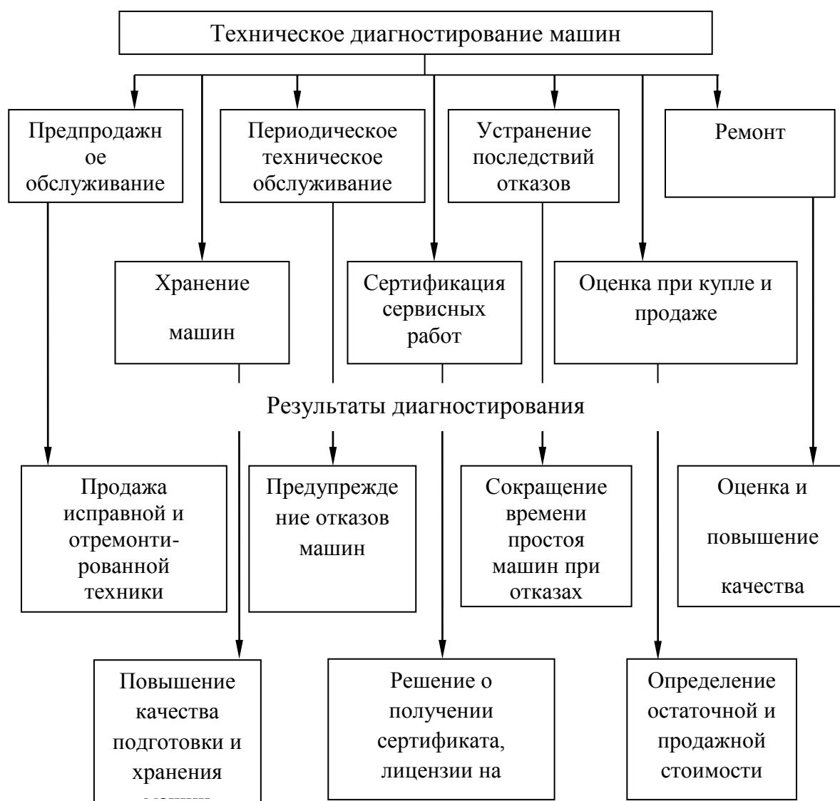
Рис. 2.2. Место диагностирования в техническом сервисе
