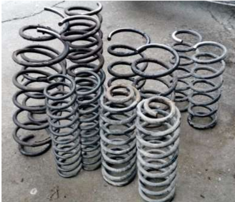
Рис. 2.1. Старение материала пружин подвески
