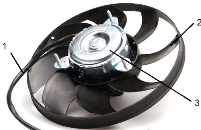
1 – соединительный кабель; 2 – крыльчатка вентилятора; 3 - электродвигатель
