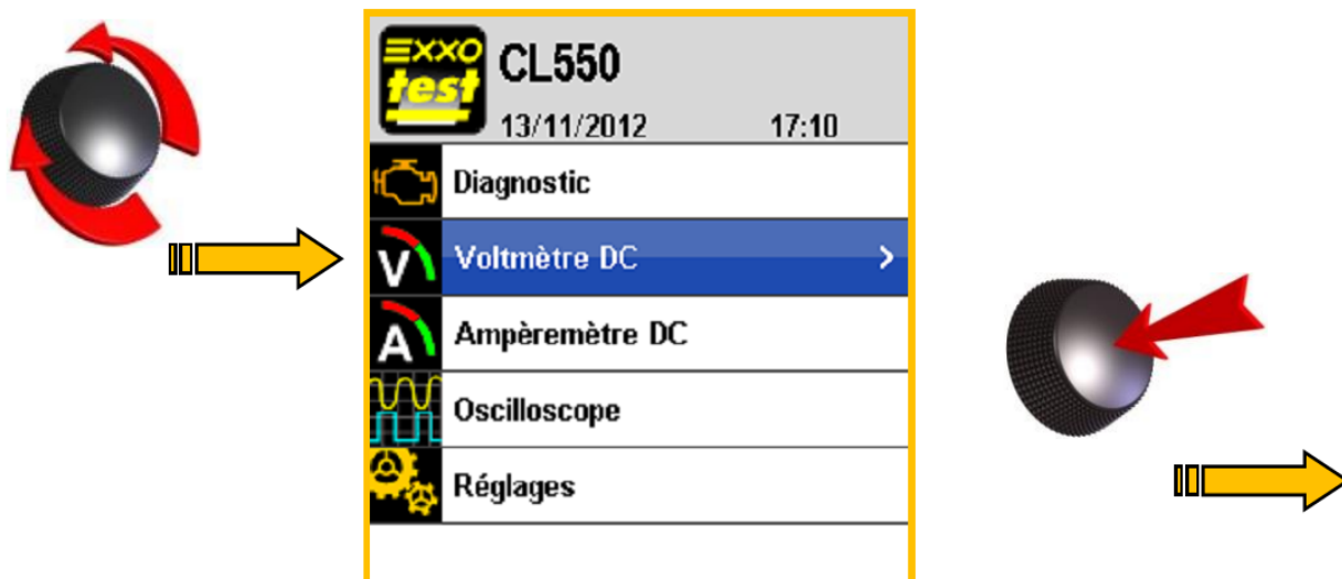
Рисунок Б2 – Использование селектора прибора CL 550
