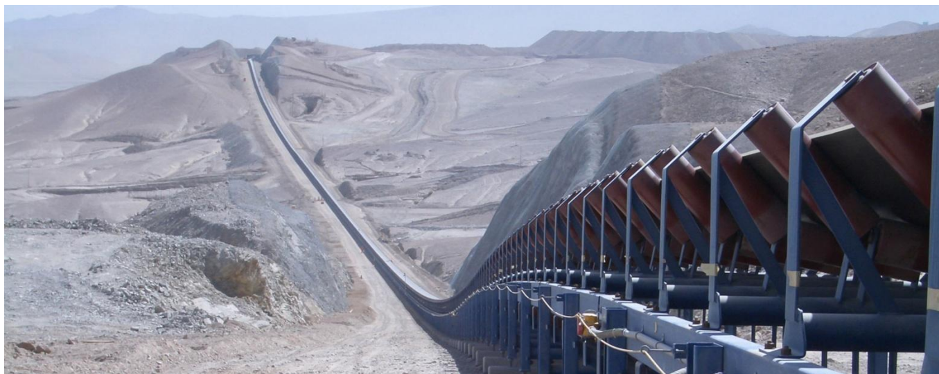
1 и 2 Грунтовые дороги промышленных карьеров. 3 Ленточный транспортёр от карьера до станции переработки
