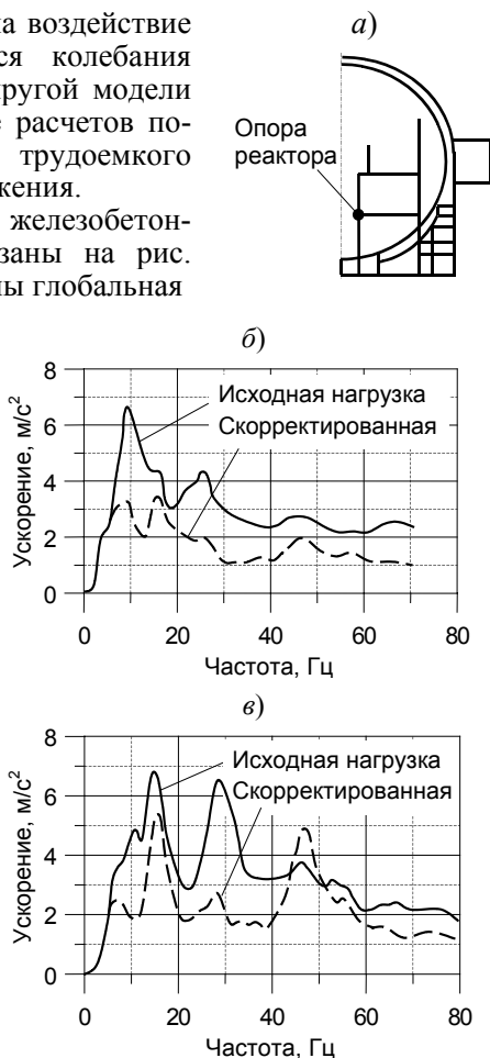
Рис. 17.14. ПС на опоре реактора:
