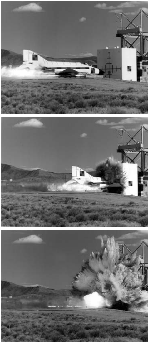
Рис. 8.20. Эксперимент по удару самолета в Sandia National Laboratories (США) [133]
