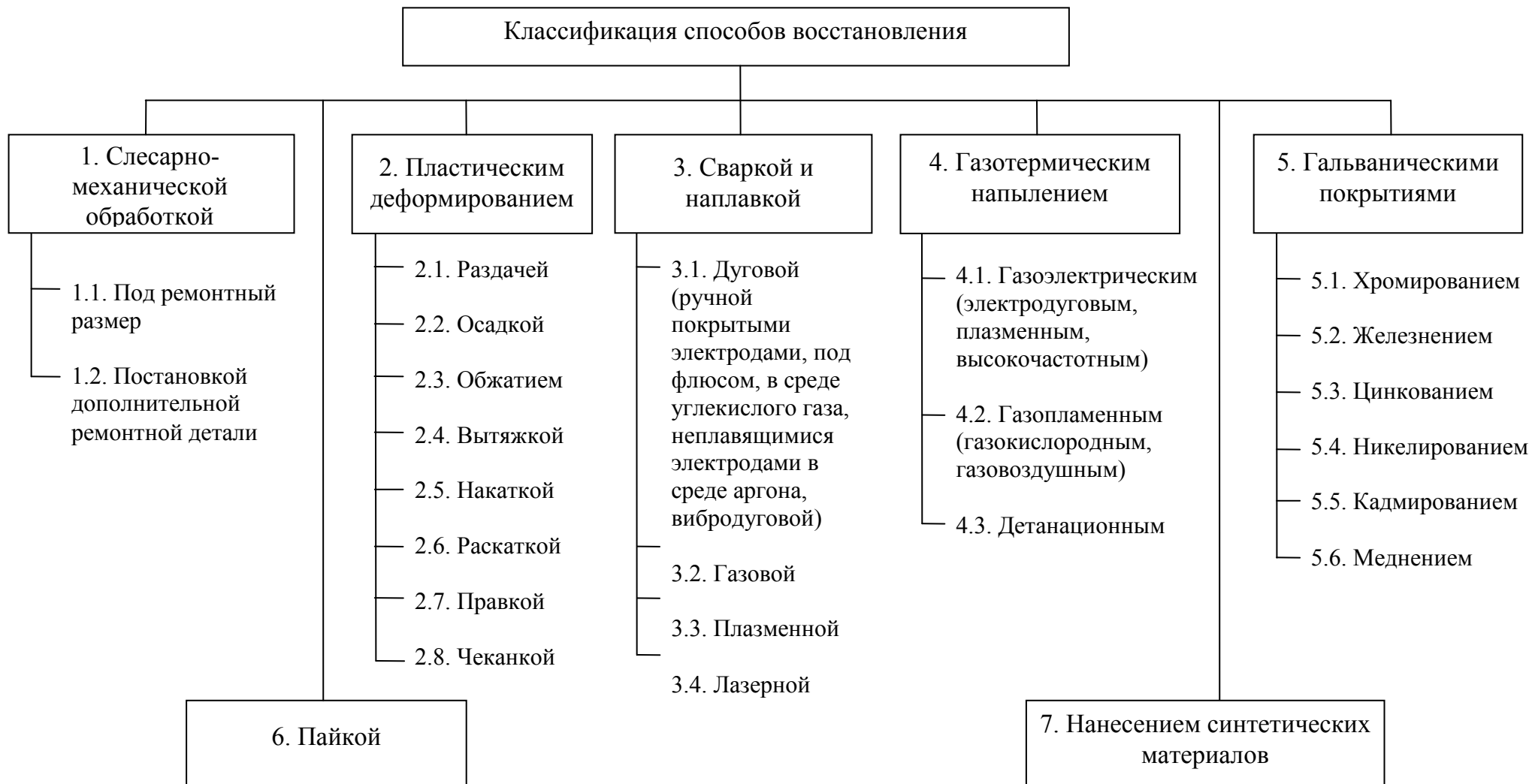
Рис. 3.2. Классификация способов восстановления деталей
