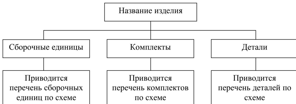
Рис. 4. Образец выполнения структурной схемы изделия
