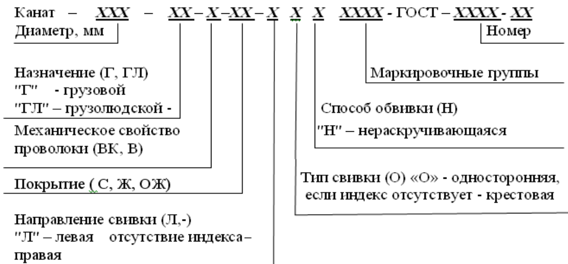
Рисунок 3.2 – Расшифровка обозначения канатов
