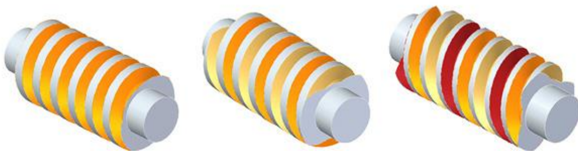
Рис. 3.1. Однозаходная и многозаходные резьбы
