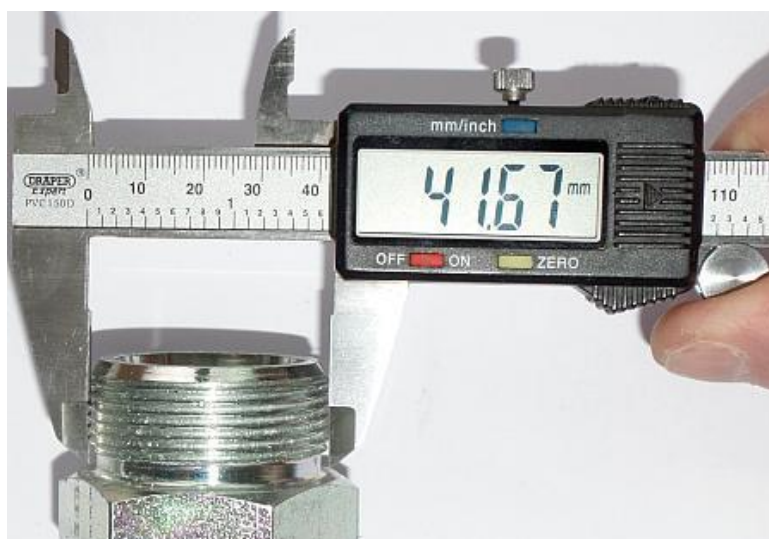
Рис. 6.2. Измерение наружного диаметра резьбы штангенциркулем
