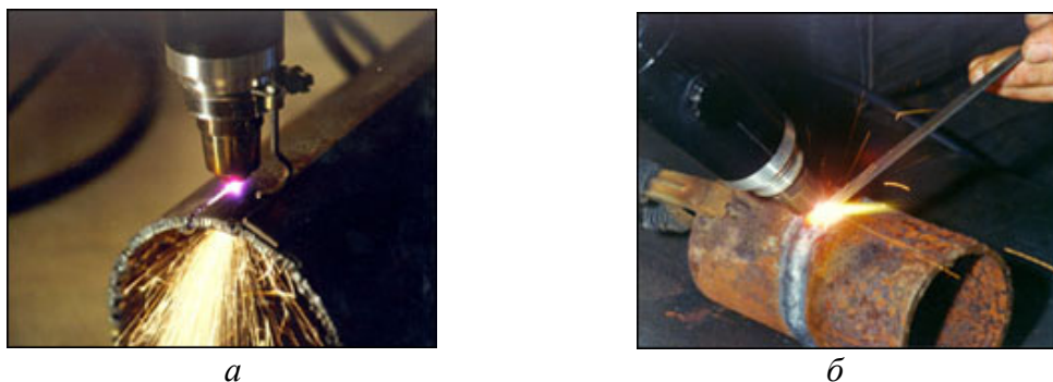
Рис. 4.3. Примеры использования аппарата «Мультиплаз-3 500»: а – резка различных металлов; б – сварка различных сталей
