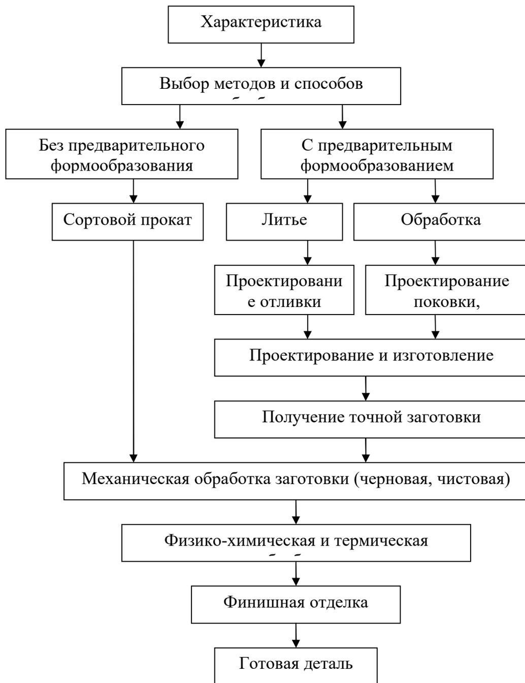
Рис. 2. Возможные варианты технологий получения деталей машин
