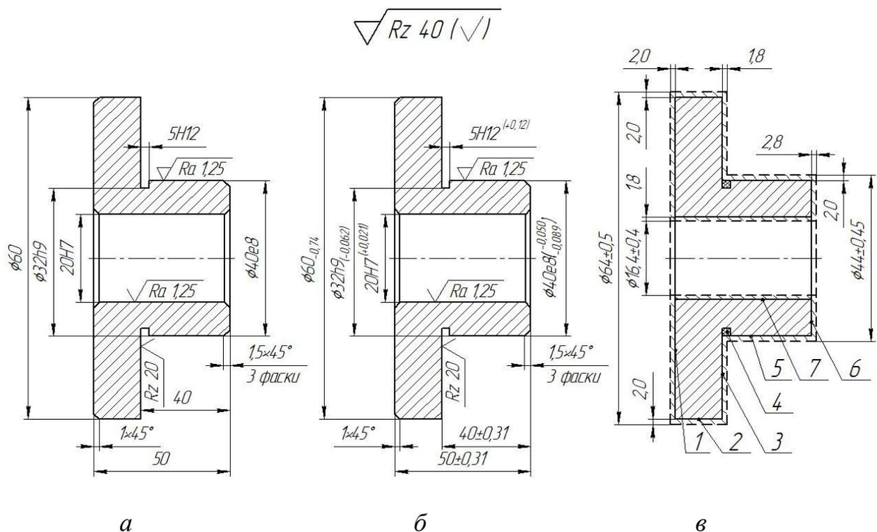
Рис. 1. Чертежи детали «Втулка»: а – **конструкторский** с неуказанными предельными отклонениями размеров валов, отверстий, остальных; б – **рабочий**; в – **заготовки** с нумерацией (слева вниз направо) обрабатываемых поверхностей и припусками на механическую обработку; материал: сталь 15X
