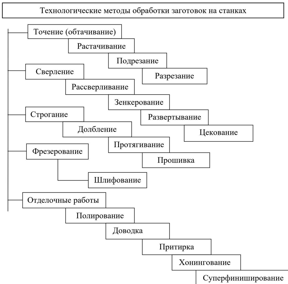
Рис. 5. Основные операции обработки заготовок резанием
