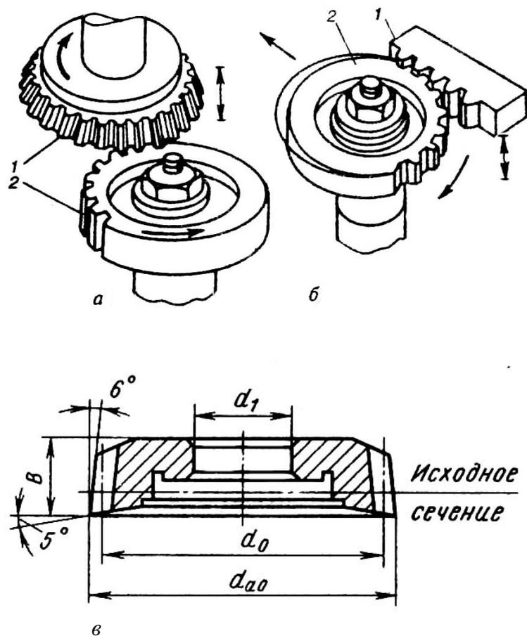
Рис. 18. Стругание зубьев шестерен: а – долбяком (б);
