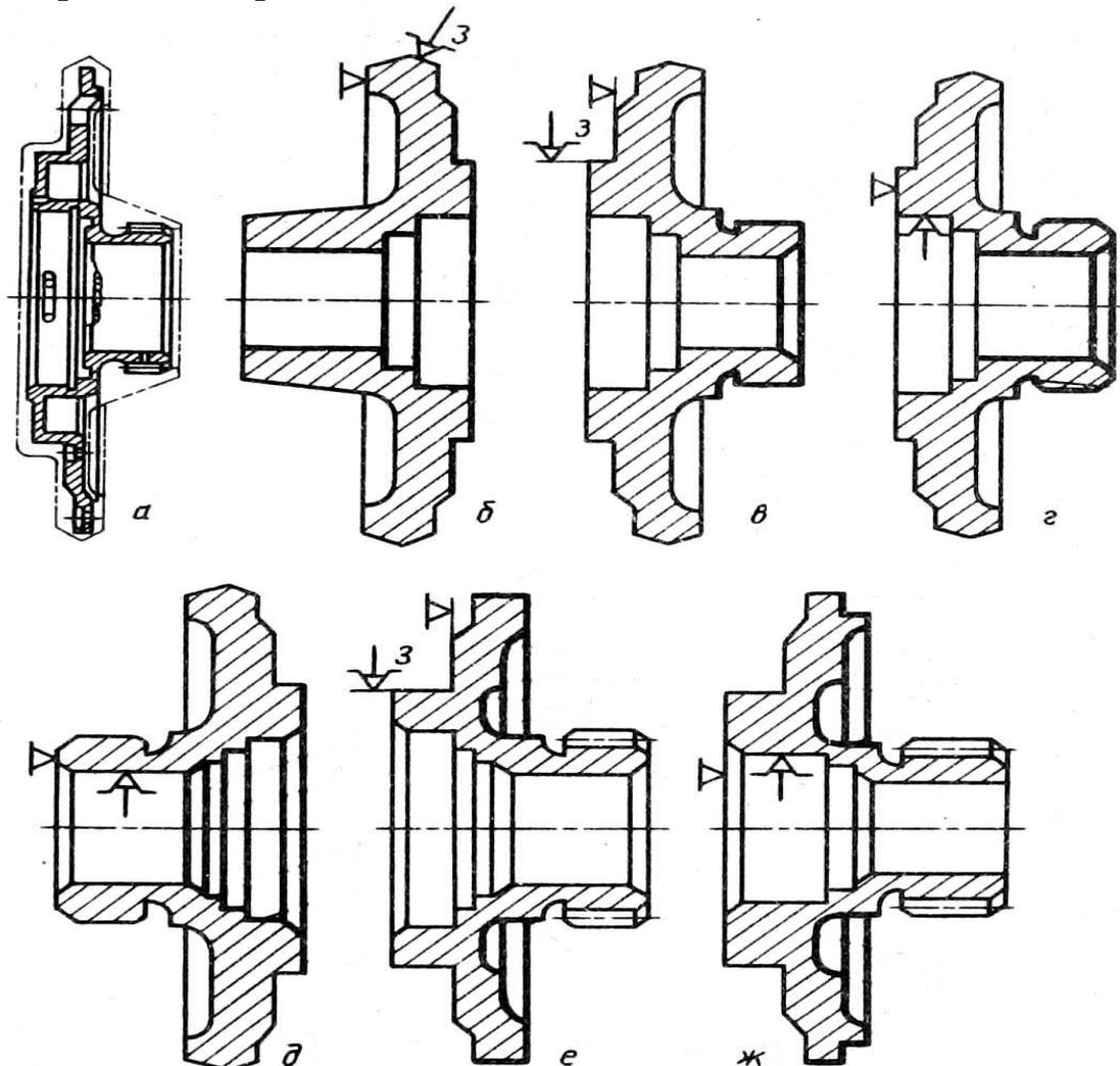
Рис. 29. Контактные технологические базы при обработке фасонной детали: *a* – деталь; *б, в, е* – закрепление заготовки и полуфабрикатов в трехкулачковом самоцентрирующем патроне при наличии опоры; *г, д, ж* – закрепление полуфабрикатов на оправке при наличии опоры; толстыми линиями указаны обрабатываемые поверхности на данной операции [3]
