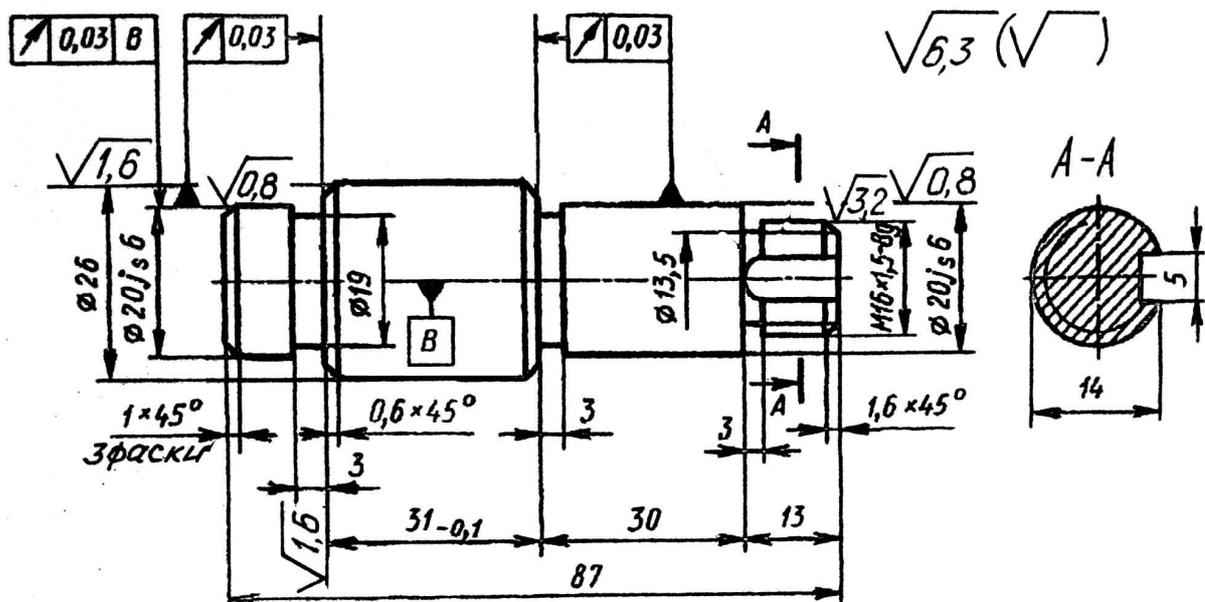
Рис. 31. Вид заготовки детали «Ось» – прокат; материал – сталь 45
