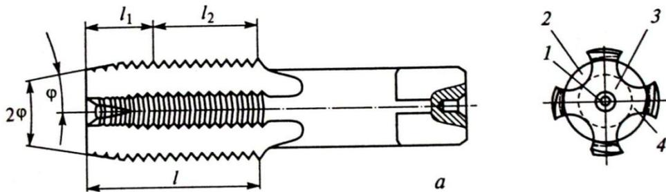
Рис. 13. Метчик для нарезания внутренней резьбы:
