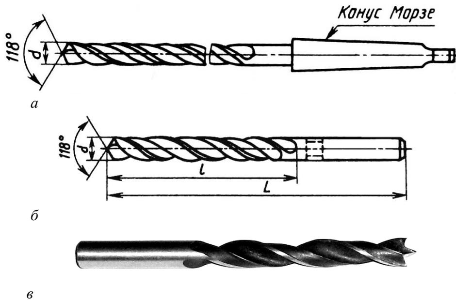
Рис. 7. Конструкции сверл: *а* – спиральное с коническим хвостовиком (для металла); *б* – спиральное с цилиндрическим хвостовиком (для металла); *в* – спиральное с цилиндрическим хвостовиком для сверления дерева, пластмасс, гипсокартона
