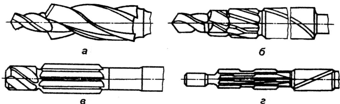
Рис. 15. Комбинированные инструменты: *a* – сверло – зенкер;
