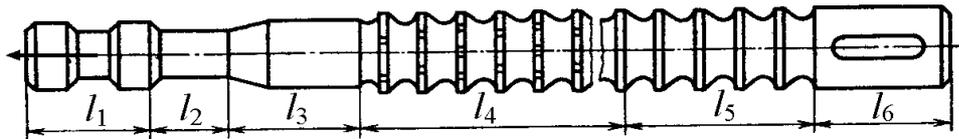
Рис. 19. Элементы круглой протяжки
