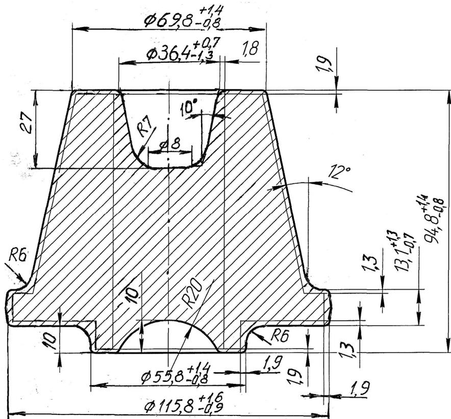
Рис.4. Чертеж заготовки-штамповки
