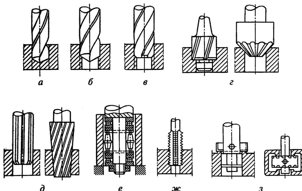
Рис. 16. Виды обработки отверстий в заготовках: *а* – сверление; *б* – рассверливание; *в* – зенкерование; *г* – зенкование; *д* – развертывание; *е* – раскатывание; *ж* – нарезание внутренней резьбы; *з* – подрезание (цекование) торцев
