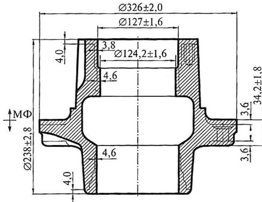
Рис.3. Чертеж заготовки-отливки
