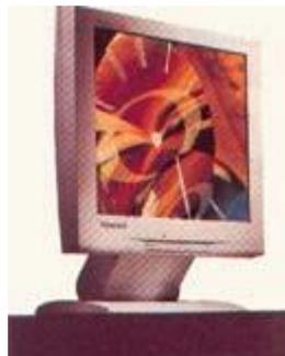
Рис. 2.18. Жидкокристаллический монитор
