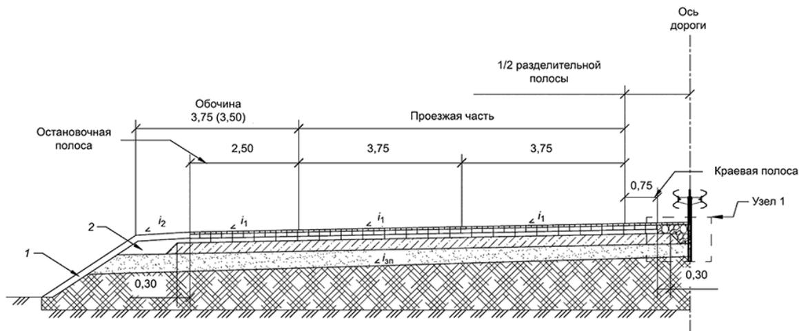
Примечание - Конструкция узла 1 приведена на рисунке А.3.
