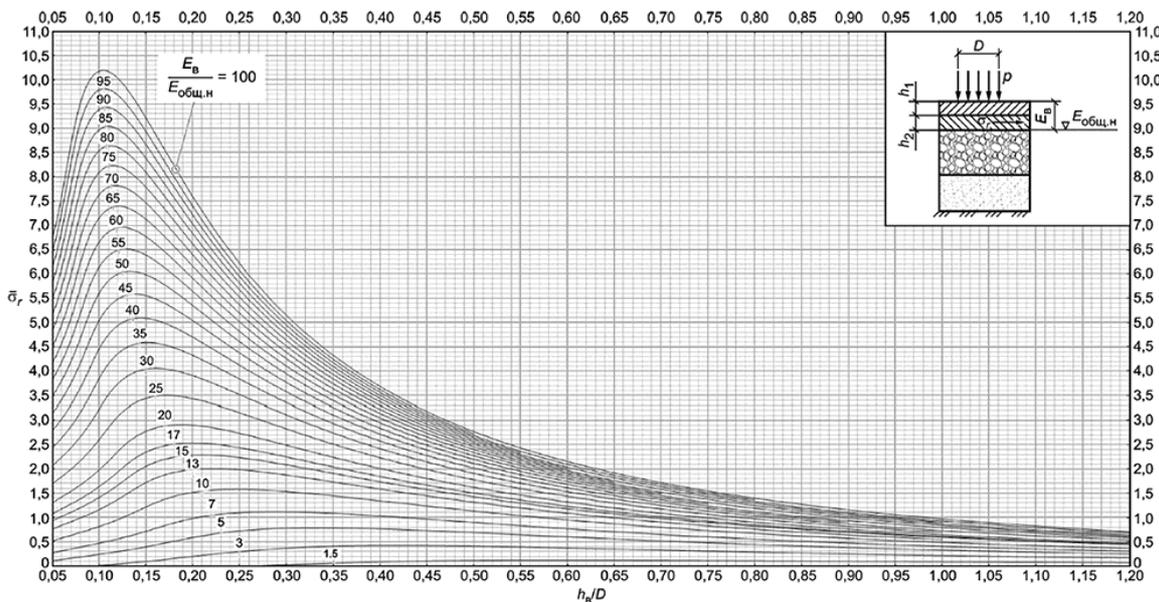
Рисунок Е.51 - Номограмма для определения растягивающего напряжения  $\bar{\sigma}_r$  при изгибе от единичной нагрузки в верхнем монолитном слое двухслойной системы при спаянном контакте на границе слоев
