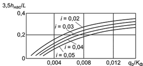
$i$  - поперечный уклон низа дренирующего слоя;  $L$  - длина пути фильтрации;  $q_p$  - расчетный объем притока воды, м<sup>3</sup>/м<sup>2</sup> в сутки;  $K_\phi$  - коэффициент фильтрации песка, м/сут
