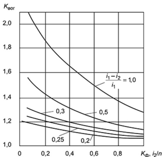
$i_1$  и  $i_2$  - продольные уклоны выше и ниже перелома продольного профиля;  $K_\phi$  - коэффициент фильтрации, м/сут;
