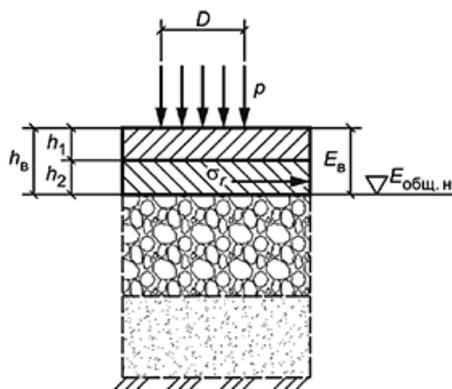
$h_B$  - верхний слой расчетной модели;  $h_1$ ,  $h_2$  - толщины отдельных слоев асфальтобетона;  $E_B$  - средневзвешенный модуль упругости верхнего слоя;  $E_{общ.н}$  - модуль упругости упругого полупространства, ниже пакета слоев из асфальтобетона, не ограниченного снизу (нижнего слоя)
