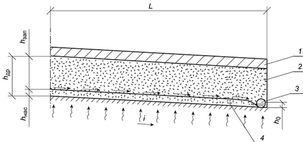
1 - слой покрытия; 2 - дренажный слой; 3 - труба-дрена; 4 - кривая депрессии;  $L$  - длина пути фильтрации;  $h_{др}$  - толщина дренажного слоя;  $h_{нас}$  - толщина слоя, насыщенного водой;  $h_{зап}$  - толщина слоя с капиллярно-связанной водой;  $h_0$  - уровень воды в трубе-дрене
