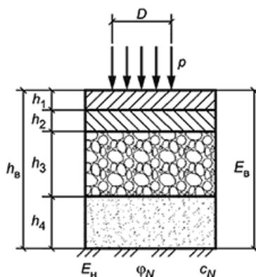
$h_b$  - верхний слой конечной толщины;  $E_b$  - модуль упругости верхнего слоя;  $E_n$  - модуль упругости упругого полупространства, не ограниченного снизу (нижнего слоя);  $\phi_N$  - угол внутреннего трения;  $c_N$  - удельное сцепление
