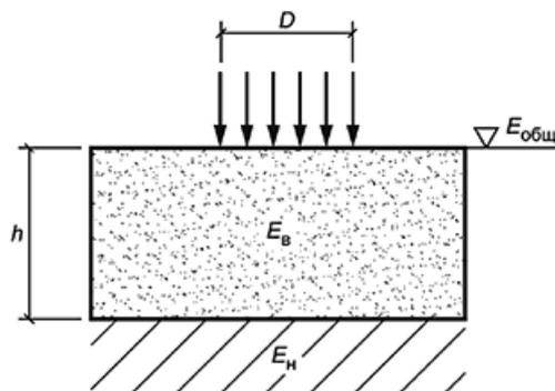
$h$  - верхний слой конечной толщины;  $E_B$  - модуль упругости верхнего слоя;  $E_H$  - модуль упругости упругого полупространства, не ограниченного снизу (нижнего слоя);  $E_{общ}$  - модуль упругости на поверхности верхнего слоя
