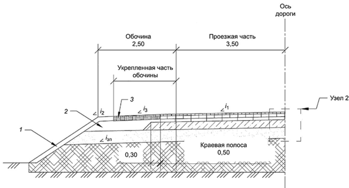
Примечание - Конструкция узла 2 приведена на рисунке А.7.
