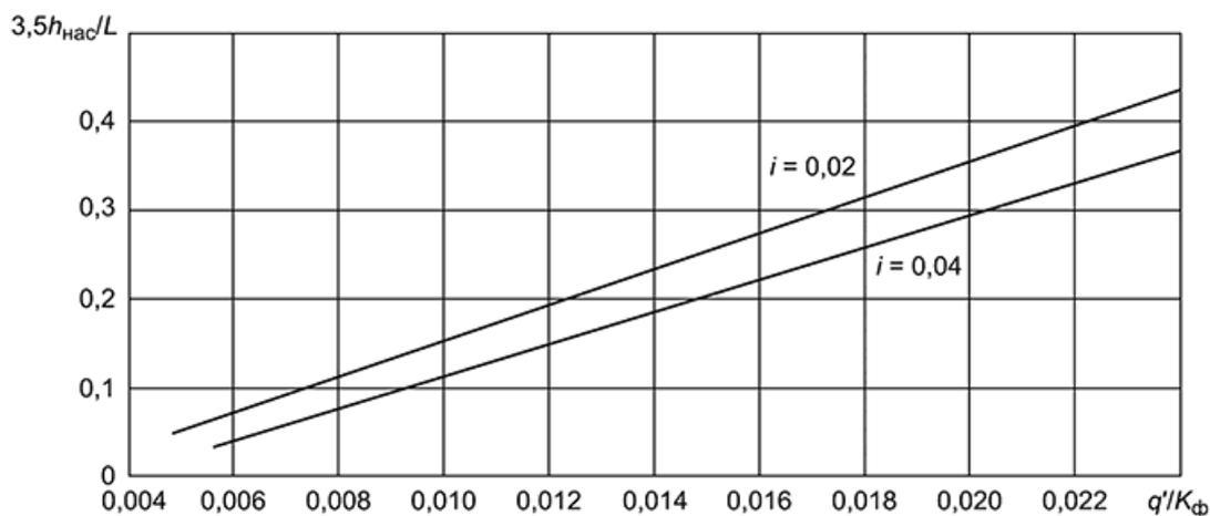
$i$  - поперечный уклон низа дренажного слоя;  $L$  - длина пути фильтрации;  $q'$  - погонный приток воды;  $K_ф$  - коэффициент фильтрации песка, м/сут
