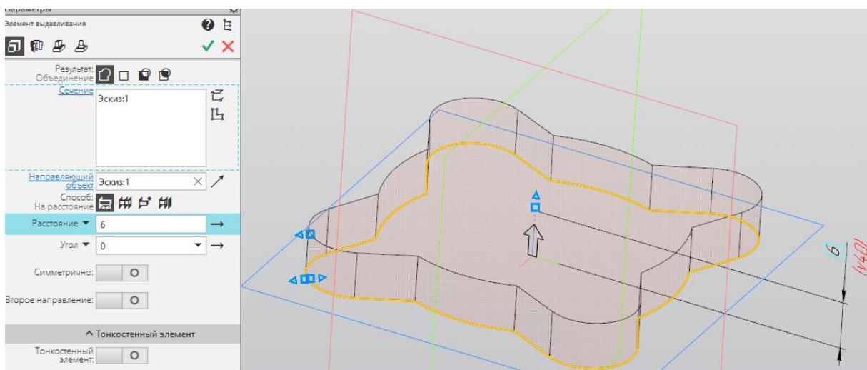
Рисунок 5.7 – Создание тела модели командой Элемент выдавливания
