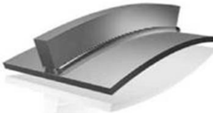
Рисунок 2 – Деформация сварного соединения
