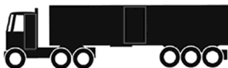
Рисунок Б.1 - Схема шестиосного седельного автопоезда (трехосный седельный тягач с полуприцепом)
