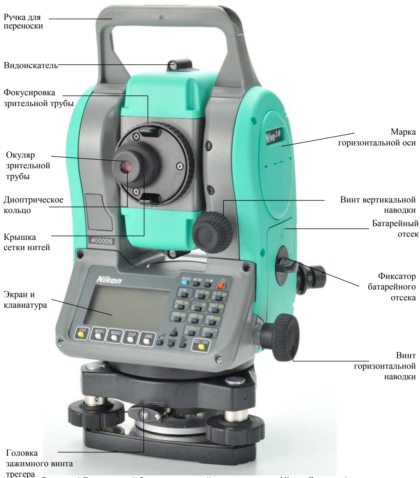
Рисунок 1 Электронный безотражательный тахеометр серии Nivo – Сторона-1
