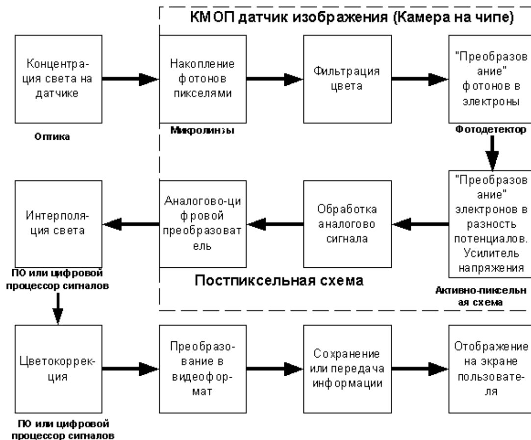
Рисунок 2.7. Роль КМОП-датчика в цифровой камере
