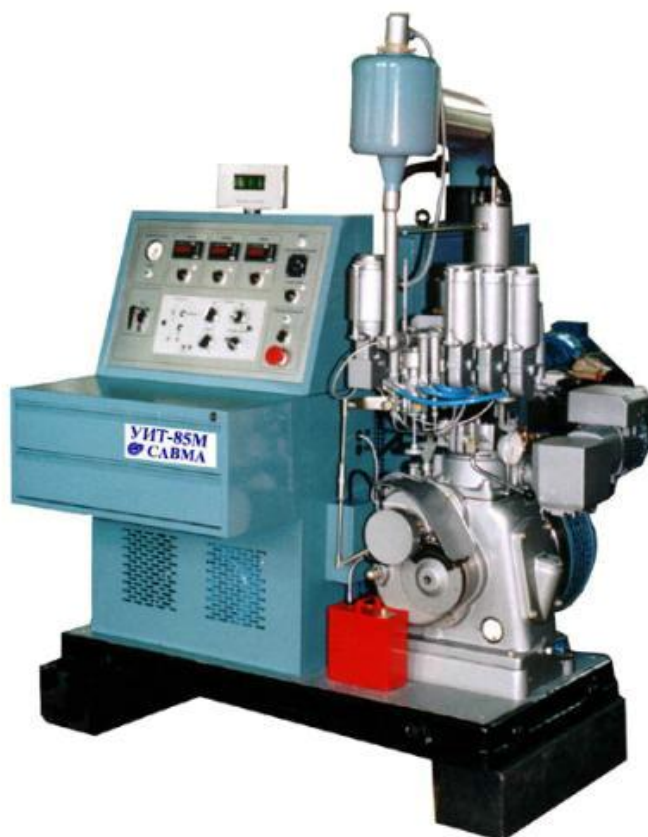
Рис. 5.2. Общий вид установки УИТ-85М для определения октанового числа бензинов
