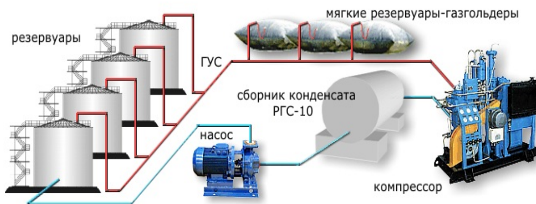
Рис. 16.4. Схема преобразования паровоздушной смеси в жидкость и ее возврат в резервуар
