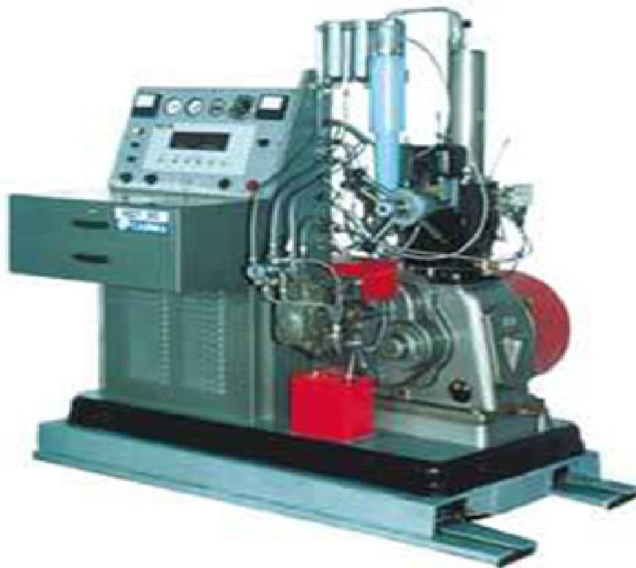
Рис. 5.7. Установка ИТД -90 для определения цетанового числа дизельного топлива
