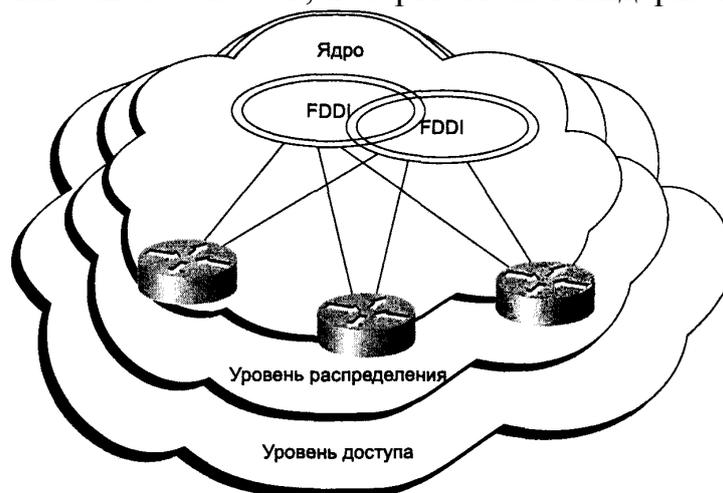
*Рис. 3.15. Реализация избыточности на уровне ядра сети за счет подключения базовых маршрутизаторов к двум высокоскоростным локальным сетям*
