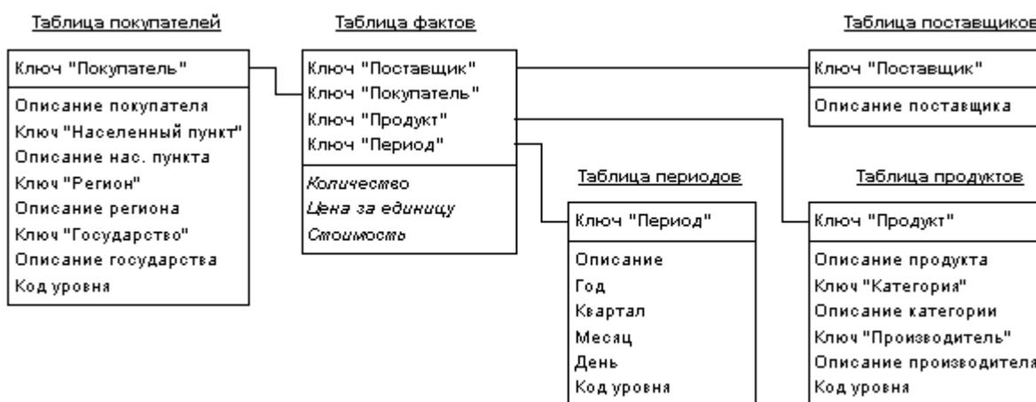
Рис. 1.7. Схема «звезда»
