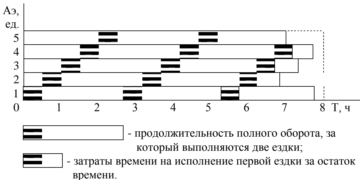
Рис. 5.23. График работы автомобилей в малой насыщенной системе (кольцевой маршрут) при V T = 32 км/ч
