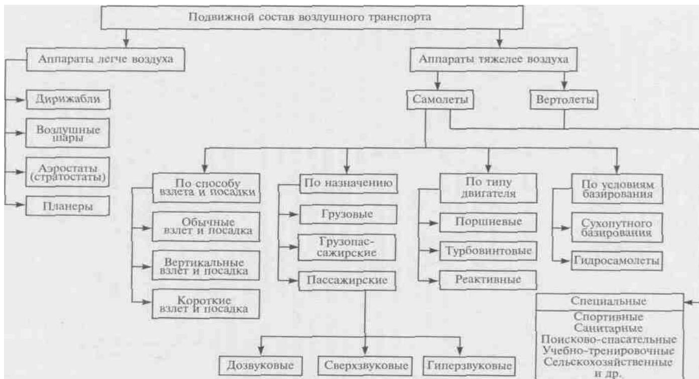
Рис. Классификация подвижного состава воздушного транспорта
