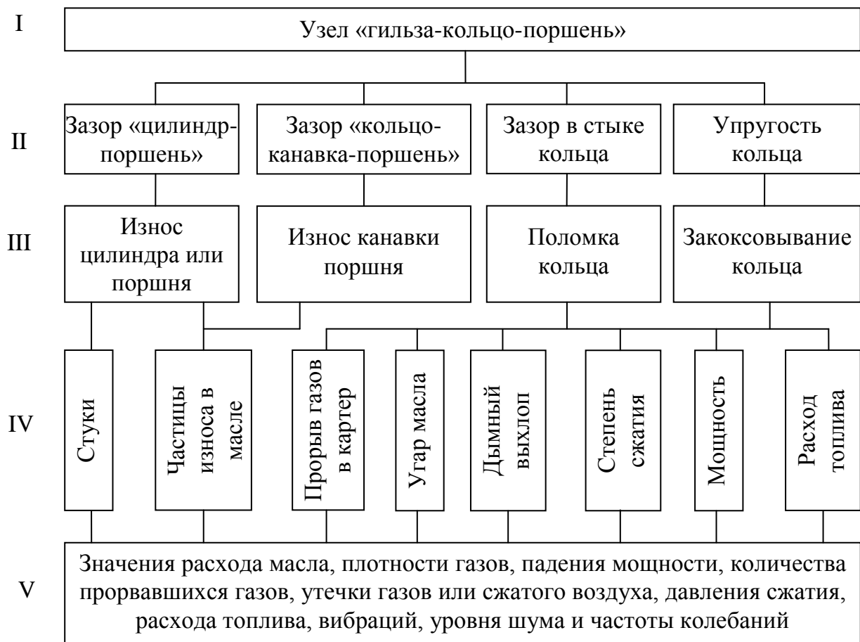
Рис. 1. Структурно-следственная схема объекта диагностирования: I – объект; II – структурные параметры; III – неисправности; IV – диагностические параметры; V – значения диагностических параметров
