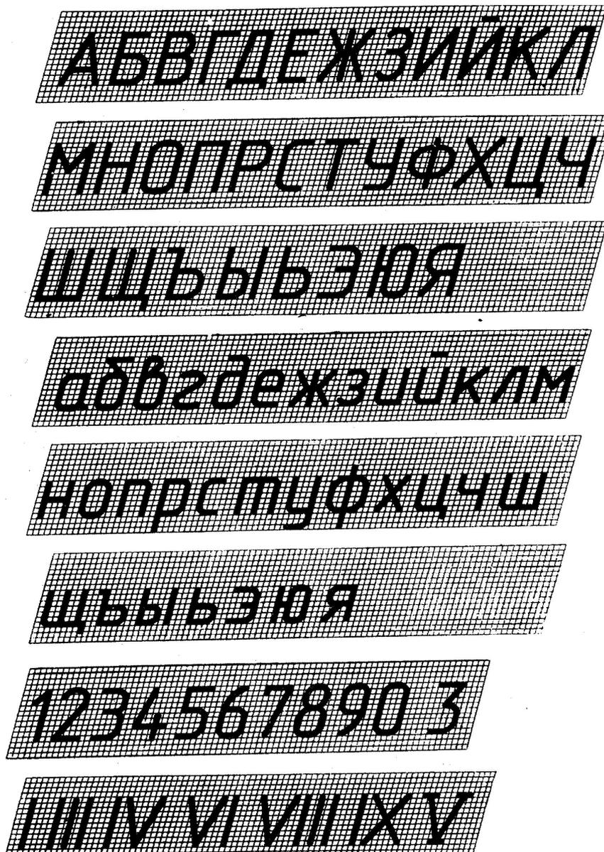
Рис. 2.3. Шрифты чертежные. Шрифт типа Б с наклоном
