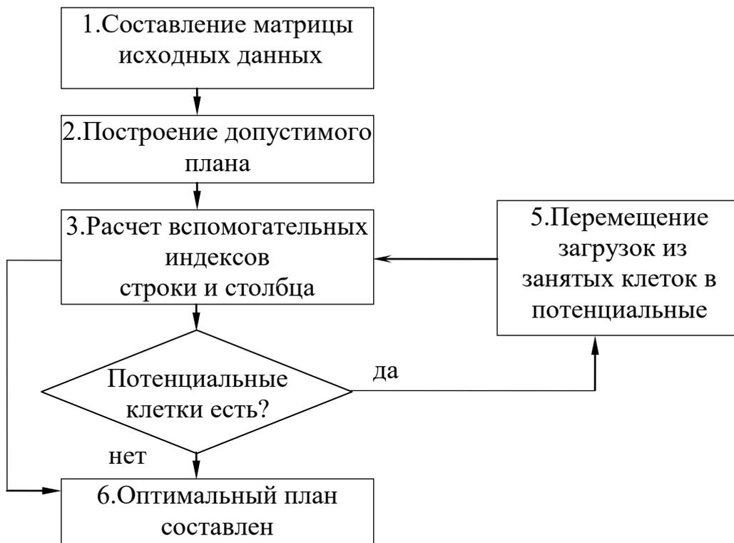
Рис. 4.1. Схема выполнения расчета
