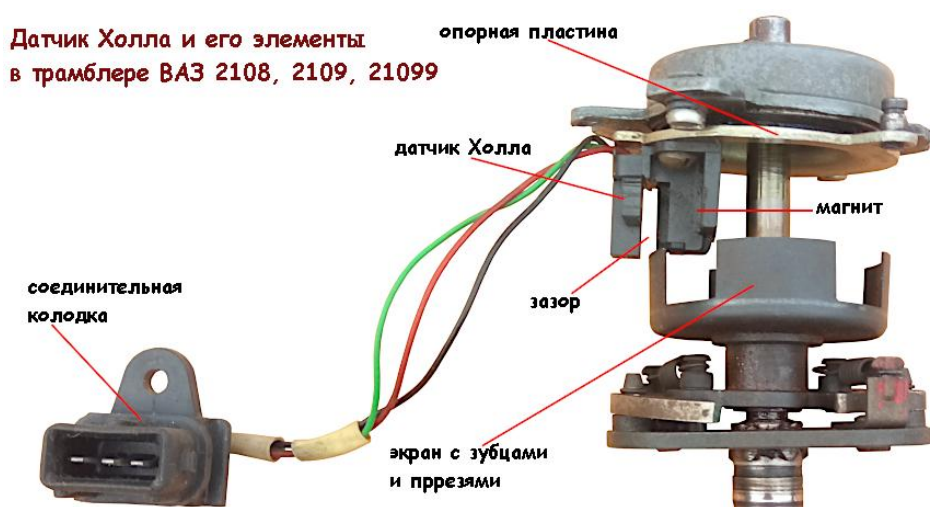
Рис. 2. Бесконтактный прерыватель-распределитель с датчиком Холла
