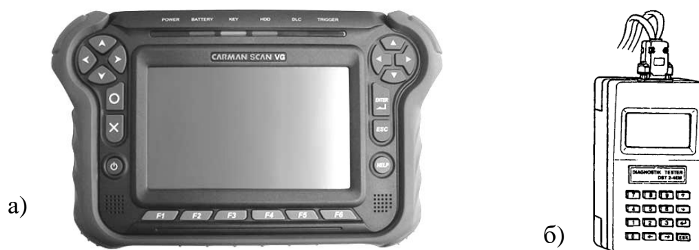
Рис. 14. Прибора для диагностики электронных систем автомобиля.
