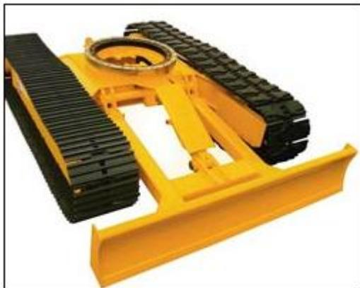
Зарубежные производители начали закладывать срок эксплуатации конструктивно в базовые детали, например, раму. Т. е. по прошествии определенного срока рама становится непригодной к использованию и не подлежит ремонту.
