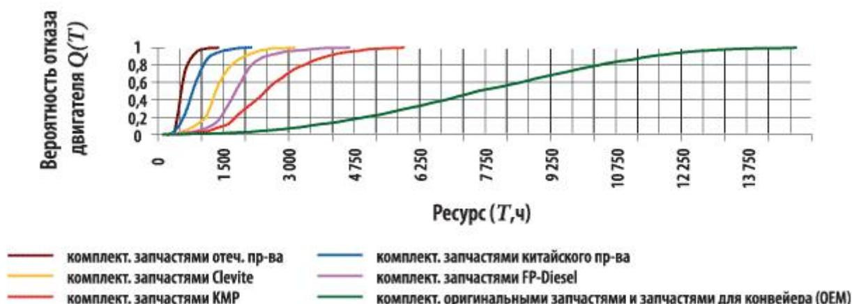
Рис. 5. Кривые вероятностей отказа двигателей D-355C после капитального ремонта при различных вариантах комплектации.
