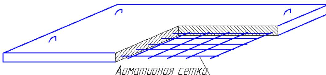
Рис. 2.124. Вид плиты перекрытия
