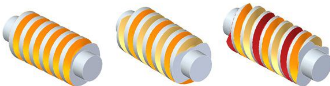
Рис. 6.1. Однозаходная и многозаходные резьбы
