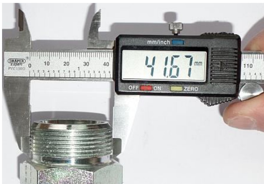
Рис 6.20. Измерение наружного диаметра резьбы штангенциркулем
