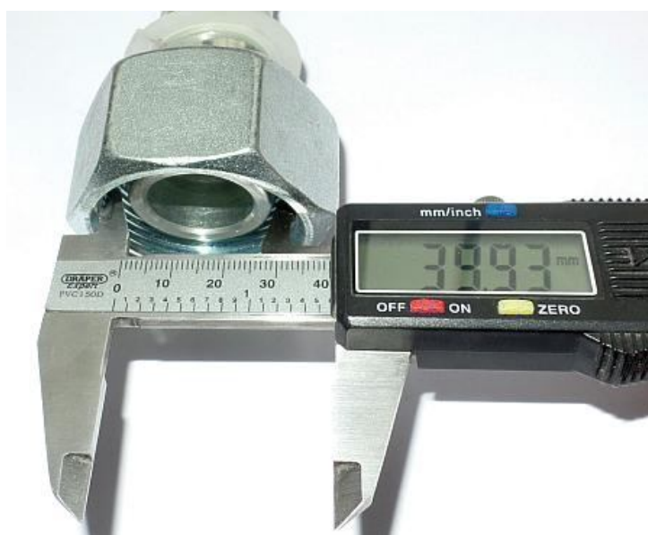
Рис 6.23. Измерение внутреннего диаметра резьбы штангенциркулем
