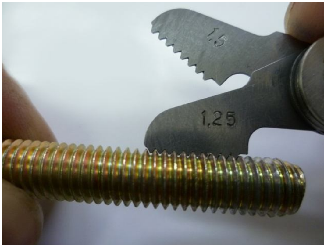
Рис. 6.22. Определение шага резьбы резьбомером
