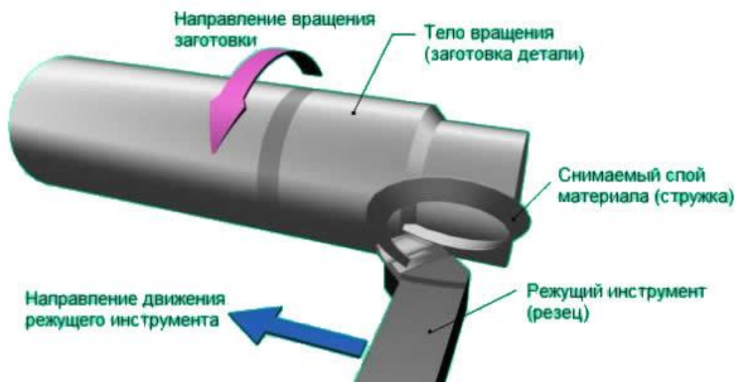
Рис. 4.12. Процесс операции точения цилиндрического участка
