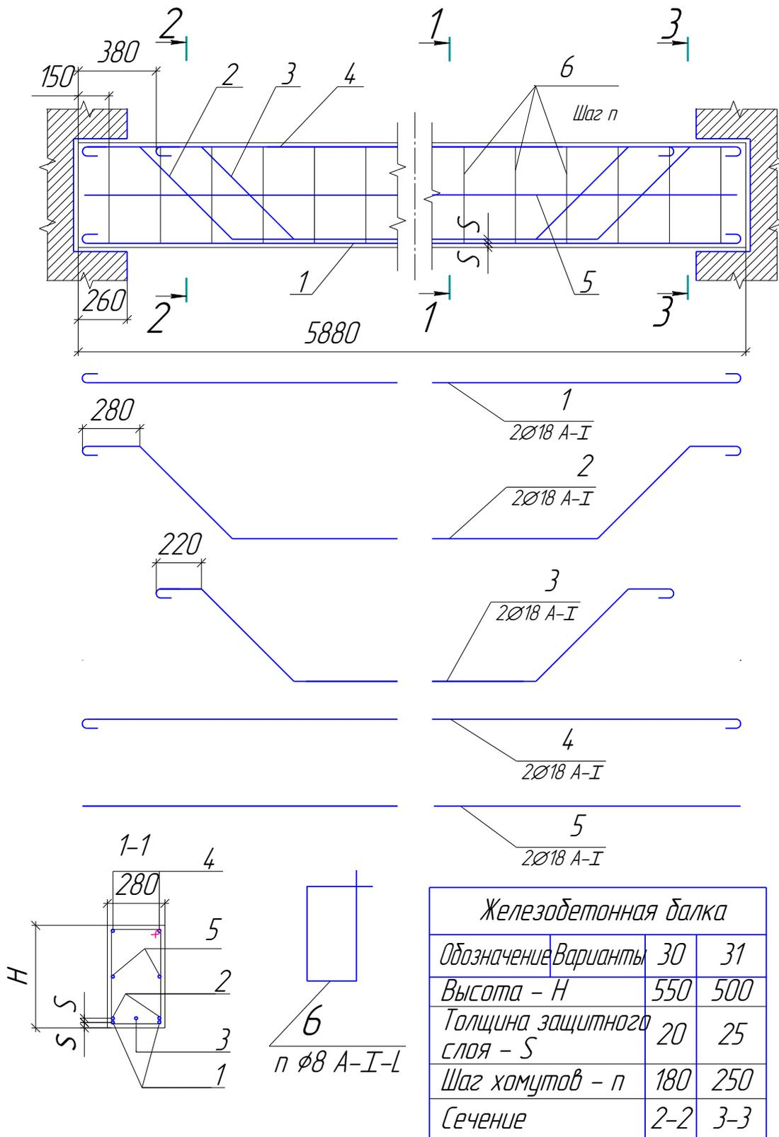
Рис. 2.131. Образец задания графической работы «Чертеж железобетонной конструкции»
