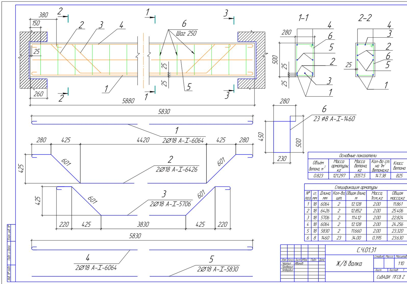
Рис. 2.132. Образец графической работы «Чертеж железобетонной конструкции»
