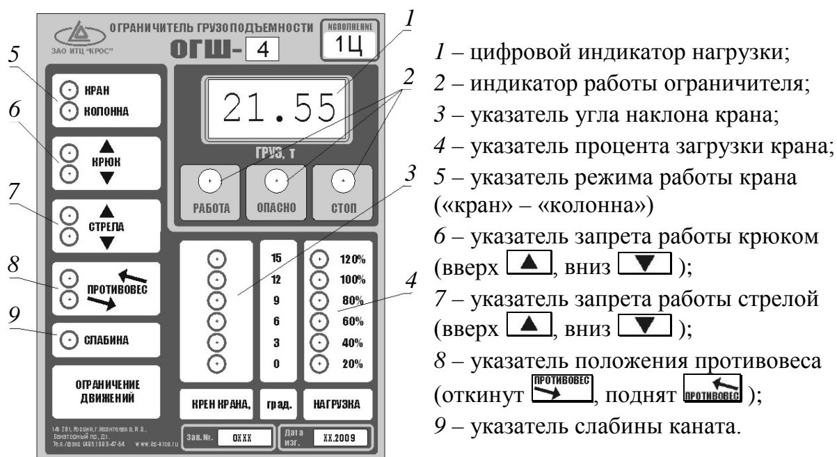
Рис. 5.13. Внешний вид передней панели БМ ОГШ-4
