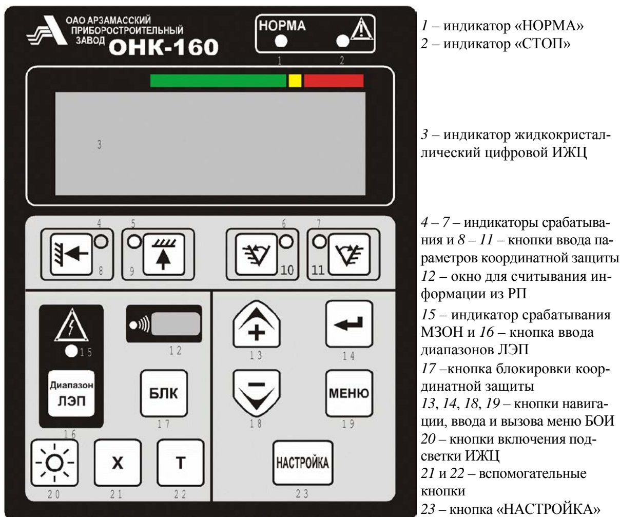
Рис. 3.36. Внешний вид передней панели БОИ ограничителя ОНК-160С
